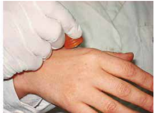
Figura 5. Recolección de muestras mediante stub para SEM-EDS.
