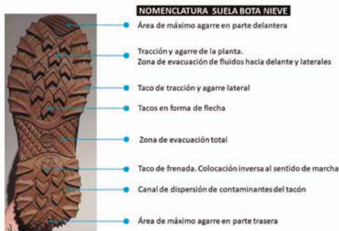
Figura 12. Ejemplo de nomenclatura específica en una suela diseñada para su uso en nieve. (Fuente: Elaboración propia).
