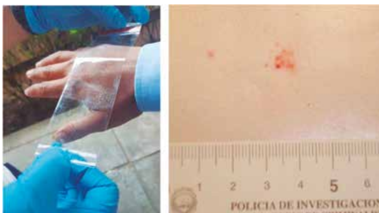
Figura 2. Recolección de muestra con cinta adhesiva sobre mano y reacción de Griess sobre papel fotográfico.
