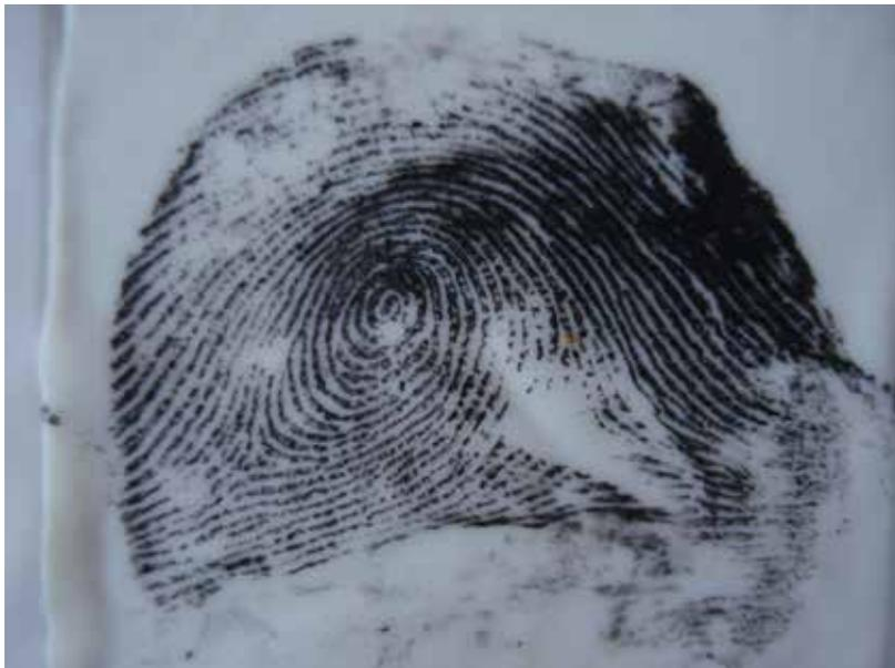
*Figura 10 Detalle del resultado de la impresión digital (dactilograma) estampada sobre guante quirúrgico, obtenida del molde de silicona.*
