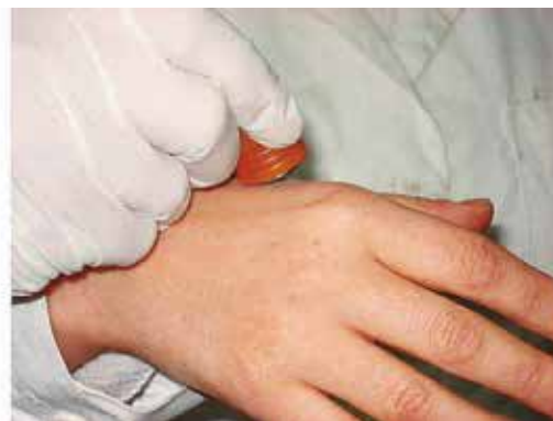
Figura 5. Recolección de muestras mediante stub para SEM-EDS.
